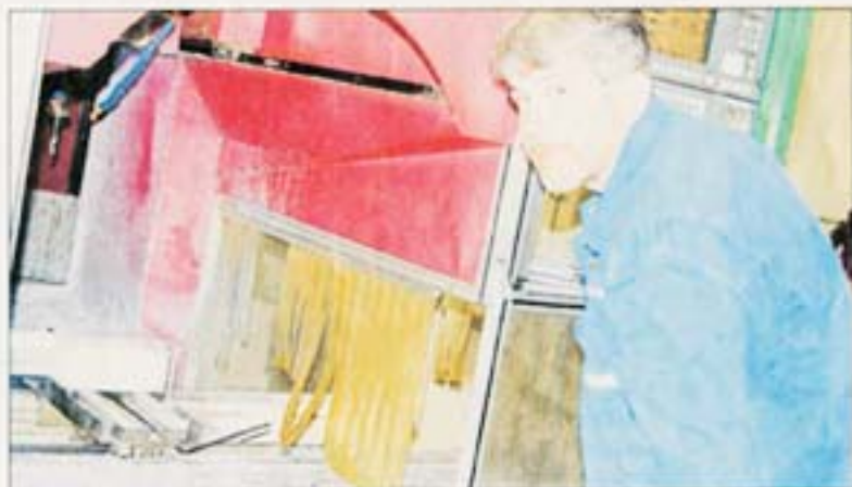
Thomas Lehnort überwacht an der Stanze, ob die in der Steuerung eingegebenen Daten auch tatsächlich aufs Werkstück übertragen werden.
